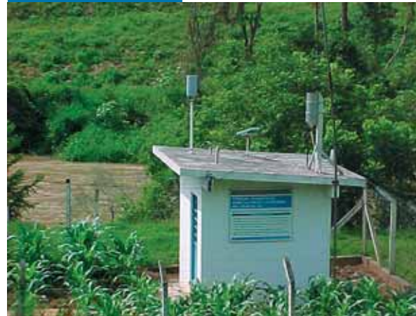
Estação telemétrica para aquisição de dados pluviométricos e fluviométricos. Fonte: IPA/FURB
