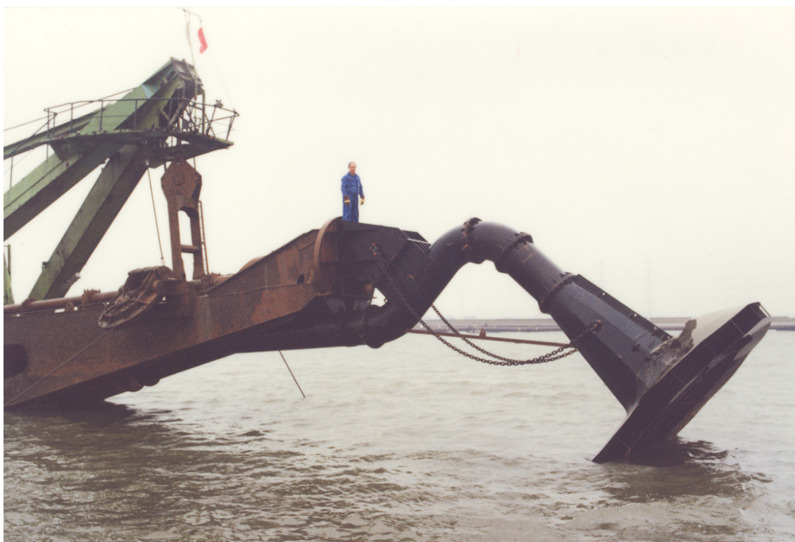
Figura 20: Difusor para descarga do material no interior do CDF.
