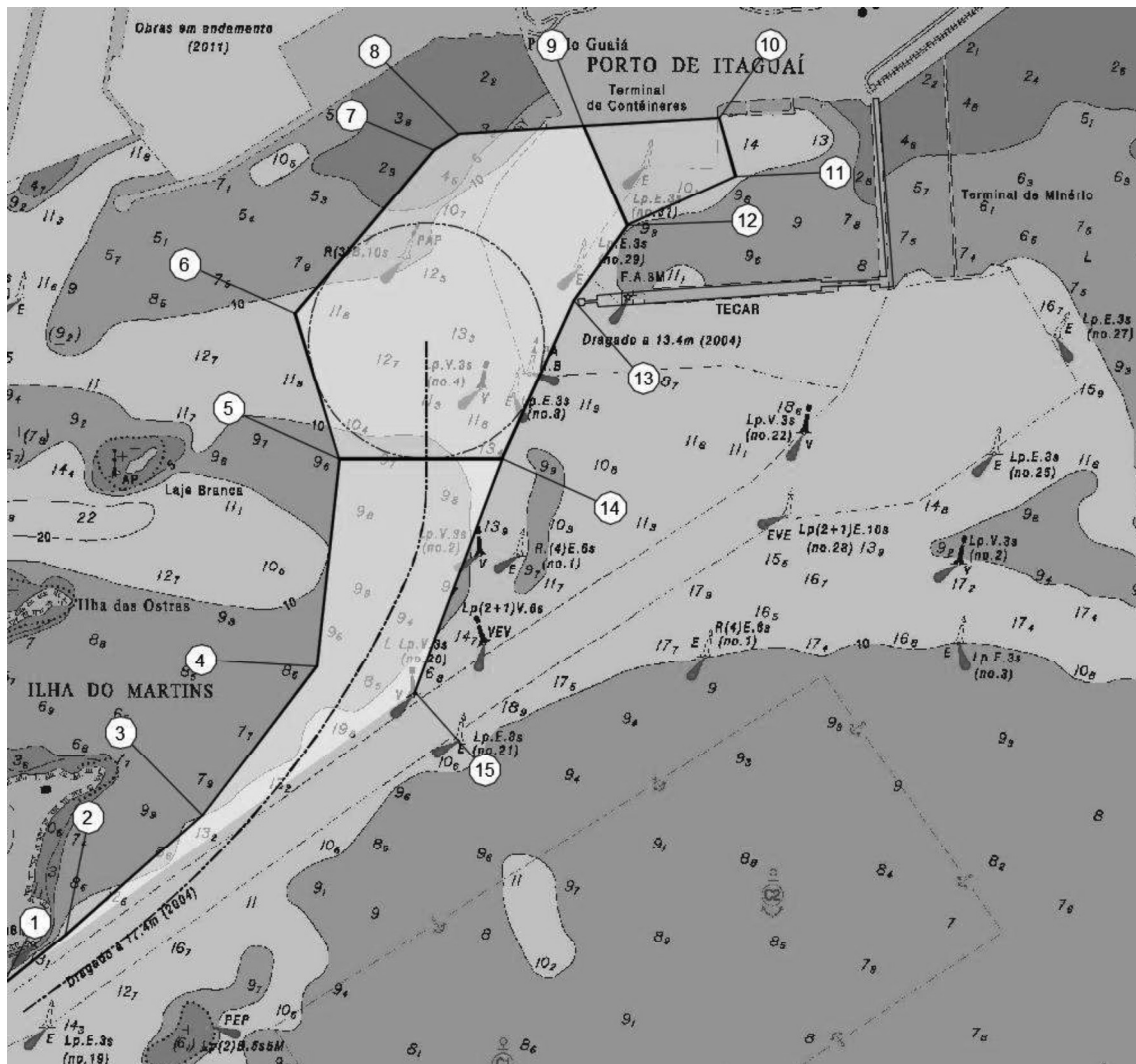
Figura 2-1 – Pontos da poligonal de dragagem.
