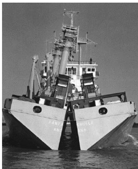
Figura 5-1– Batelão Tipo Split Hopper Dredger
