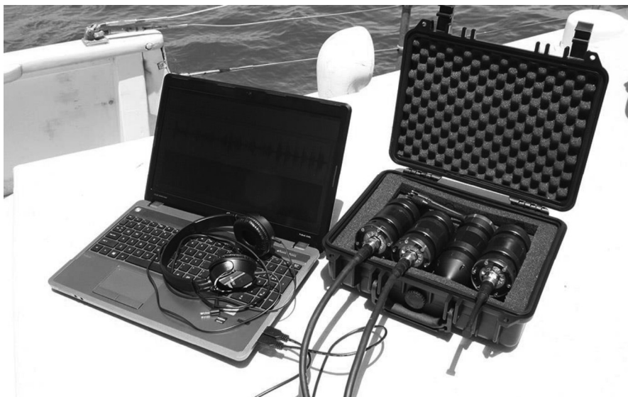
Figura 3.2-42: Sistema da estação móvel de gravação similar ao que será instalado a bordo da embarcação de pesquisa.
