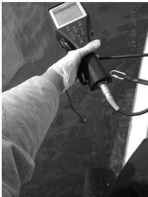
Figura 3.2-89: Determinação dos parâmetros in situ com sonda multiparamétrica durante a campanha de caracterização da qualidade da água da área de dragagem realizada em agosto de 2017.
