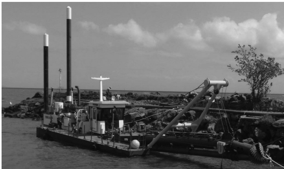
Figura 2.1-10: Exemplo de uma draga tipo CSD. Fonte: DAMEN (2017)
