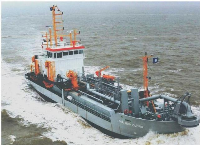
Vista da Draga THSD com tubo de descarregamento na cisterna na proa da embarcação
