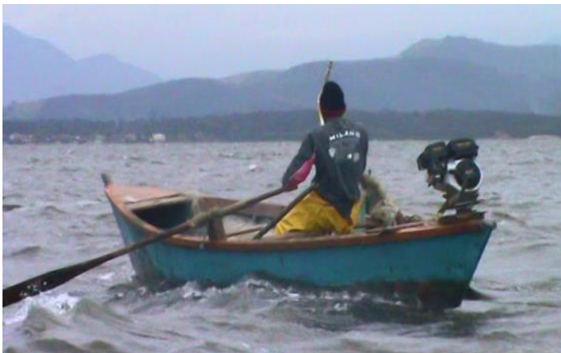
Figura 3 – Embarcação movida pelo “motor de rabeta”, o que relativamente facilita a pescaria feita por um único pescador
