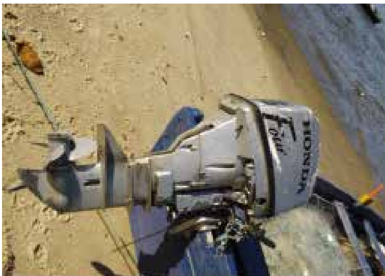
Figura 4: Motor de popa de 15HP da marca Honda. Fonte: NUTEMC/UERJ, 2014.
