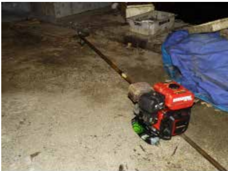
Figura 5: Motor com potência de 7HP da marca Kawashima, cujo valor varia entre R$ 600,00 e R$ 800,00, se comprado novo. Observe na foto que a haste que liga a hélice ao motor tem um pedaço de madeira improvisado pelo pescador. Fonte: NUTEMC-FFP-UERJ/2014)
