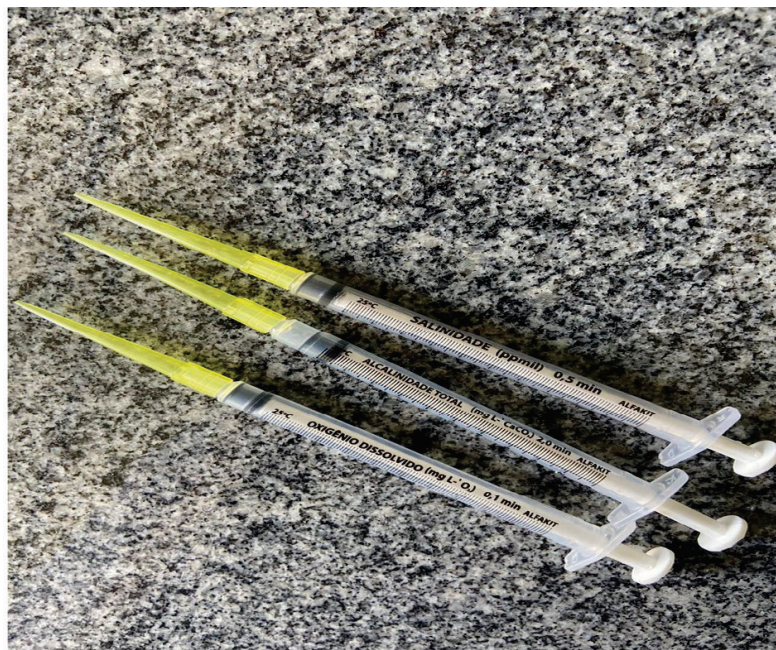
Figura 3 – Seringas para as titulações de alcalinidade ( \text{mg.l}^{-1} de \text{CaCO}_3 ), de salinidade (ppm) e de oxigênio dissolvido ( \text{mg.l}^{-1} de oxigênio).
